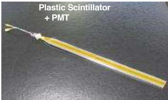
**IMC Scifi size :  $1 \times 1 \times 448 \text{ mm}^3$**
